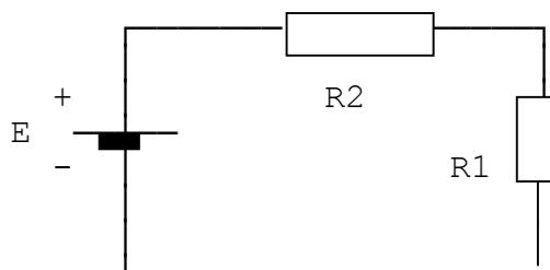
Discuta qué sucede con  $V_1$  si varía  $R_1$  mientras  $E$  y  $R_2$  se mantienen constantes.
